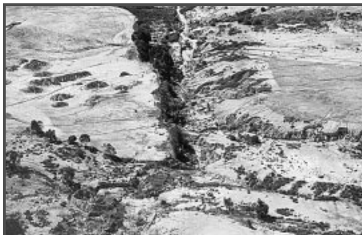
La acusada erosión en las áreas dedicadas a la extracción de áridos provoca la total colmatación de los cauces aledaños (en la foto, cabecera del arroyo del Colmenar).
